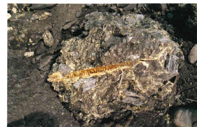
3 Injection test 1 in muck pile, detailed view of excavated consolidated material Injektionsvorversuch 1 in Haufwerk, Detailansicht eines ausgegrabenen verfestigten Bereiches
