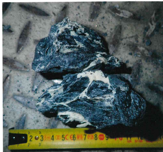
9 Injected and consolidated rock from TBM 1 Injiziertes und verfestigtes Gestein aus TVM 1
